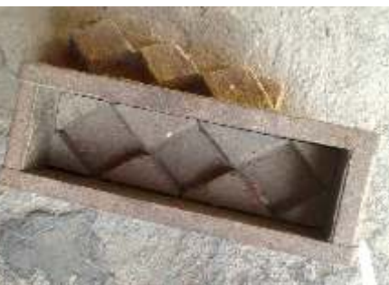
Drveni kalup za izradu reljefnih opeka. Babina Greda
